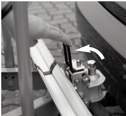
Mit einer Hand den Träger stützen, mit der anderen den Hebel für Abklappmechanismus ziehen und Träger langsam abklappen lassen.
